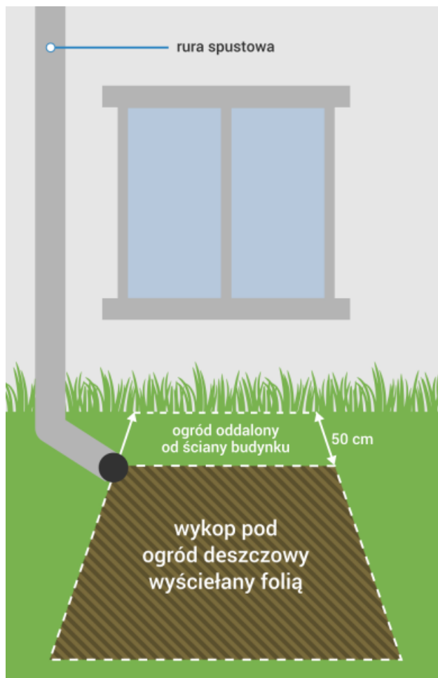
Rysunek 1. Lokalizacja ogrodu deszczowego wyściełanego folią przy budynku
